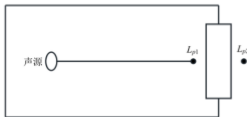
图 6-5 室内声源模型图
